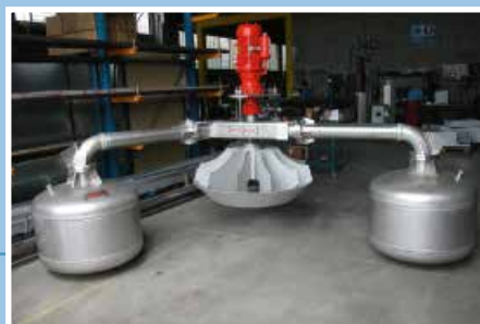
Montaggio in officina di aeratore di superficie tipo ASP-G in acciaio inox. Factory assembling of a surface aerator type ASP-G in stainless steel.
