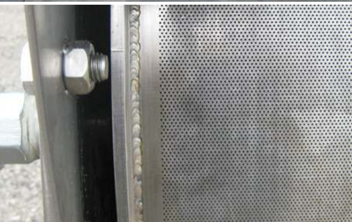
05-0352 Tamburo con fori circolari (per impianti a membrane).
