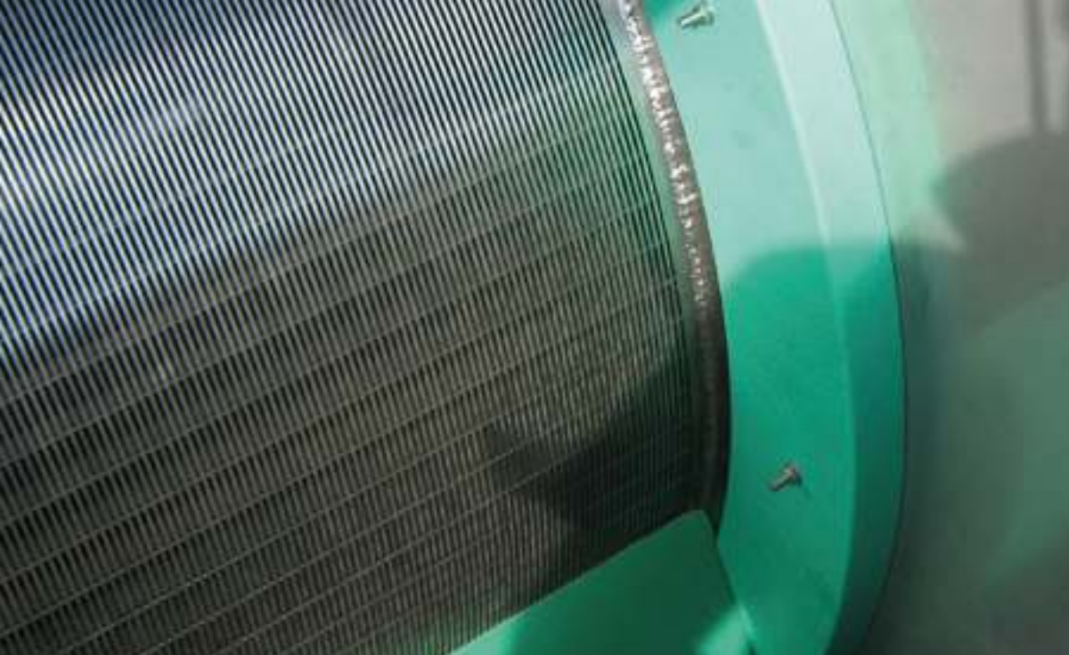
05-0352 Dettaglio tamburo filtrante a barre trapezoidale.
