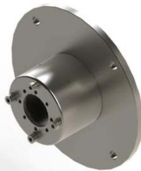
Elemento di collegamento tra il corpo pompa ed il motore. Consente di installare motori a norma IEC con flangia B5.
